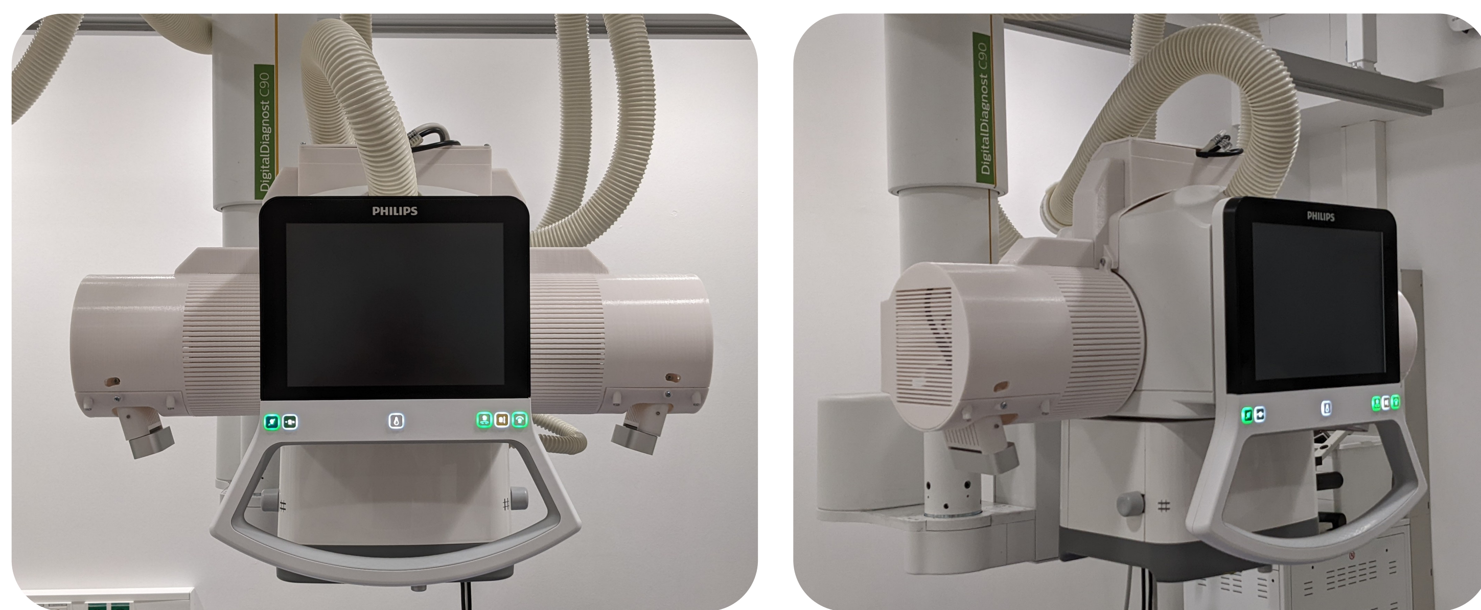
Abb. 3: Aufnahme der 3D-gedruckten ToF-Kamera-Röntgengeräteintegration.
