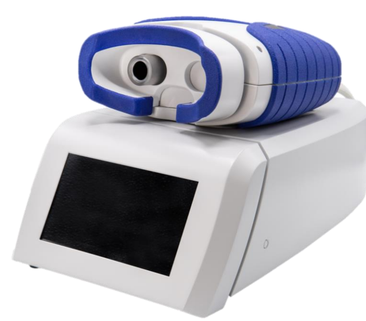
Prototyp des Home-OCT-Systems
