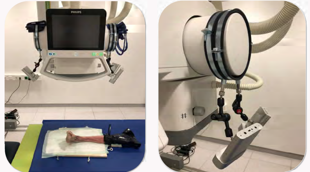
Abb. 3: a) Anatomisches Präparat unter der Röntgenröhre in typischer Position für eine anterior-posterior Aufnahme des OSGs. b) Exemplarische Position von zwei Time-of-Flight Kameras für die Erfassung der Präparatposition.
